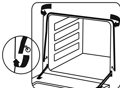
Когда Вы моете плиту внутри, резиновое уплотнение двери духовки лучше снять, вынув металлические скобы из отверстий.
